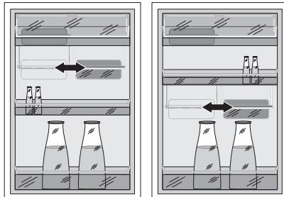
2. При установке полки на другую высоту, пожалуйста, проделайте вышеописанную процедуру в обратном порядке. Передвижную коробку можно также подвесить сбоку на одной из полок холодильного помещения:
